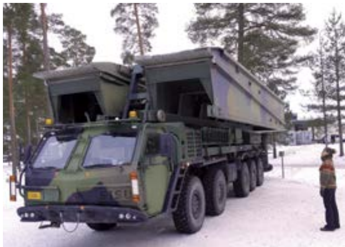
Sisu silta-ajoneuvo sillan pituus 26 m.
