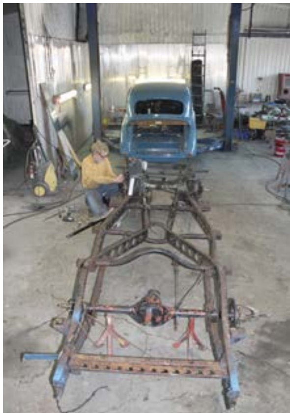
Lokakuulle tullessa oli aika nostaa kunnostettu kori erilleen rungosta. Kuvassa Mikkola kunnostaa jarrujärjestelmää.
