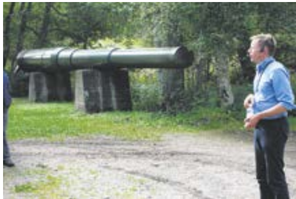
12 tuuman Obuhov-tykin vaihtoputki on hankala siirrettävä, sillä se painaa 50 tonnia ja on lähes 16 metriä pitkä. - Putki tulisi vaihtaa aina 150 laukauksen jälkeen, mutta taistelutilanteessa niillä on ammuttu jopa useita satoja laukauksia, kertoo mainio oppaamme Daniel Wilson. Kuvan vaihtoputki on käyttämätön.
